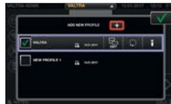
Profile für Fahrer und Arbeitsgeräte mit einfacher Änderung über jedes beliebige Bildschirmenü. Speichern aller Einstellungsänderungen im ausgewählten Profil.
